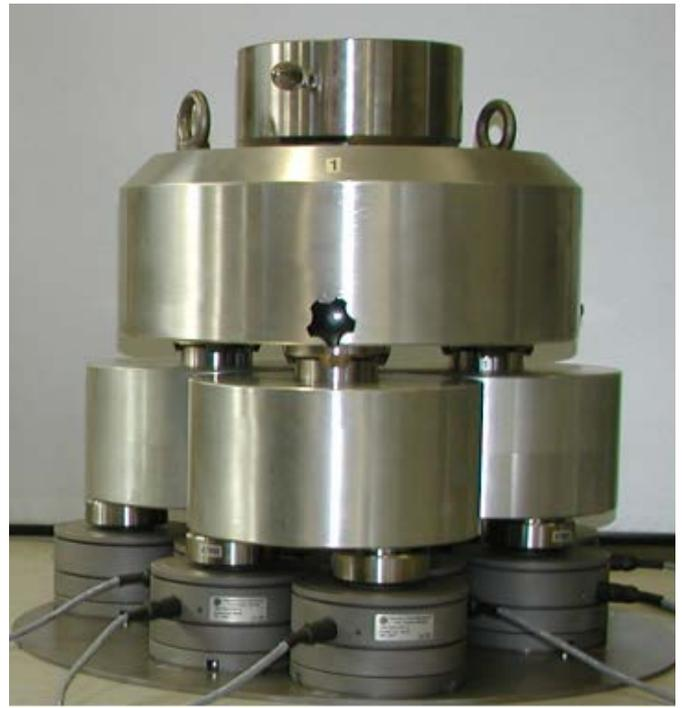
Figure 5. Build-Up-System 900kN.
